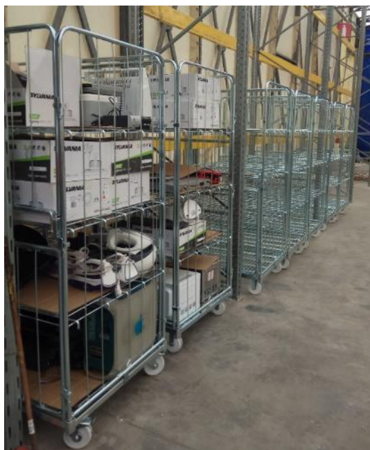
Εικόνα 4: Τοποθέτηση των συσκευών προς περαιτέρω προετοιμασία για επαναχρησιμοποίηση σε ειδικά μέσα συλλογής της μονάδας. Κωδικοποίηση κάθε υποκατηγορίας ανά αποστολέα (ιχνηλασιμότητα). (Δοκιμαστική παραλαβή).
